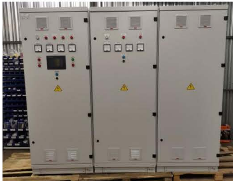
ИЗГОТОВЛЕНИЕ И ПОСТАВКА ЩСН, ШОТ, ШЗТТ, ШЗТН И ДР. НА ВЭС 30 МВт «ЖАНГИЗТОБЕ»
